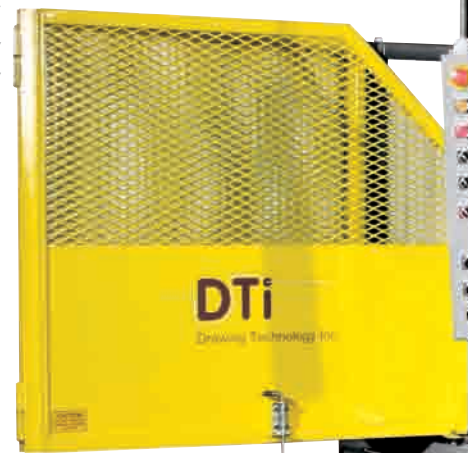
100型 | 图中所示当门处在打开位置时，具有安全保护功能和悬挂式操作控制器
