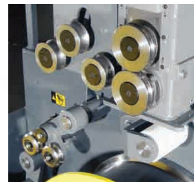
气动自动盘料头滚轮、动力进料装置和线材滚轮
