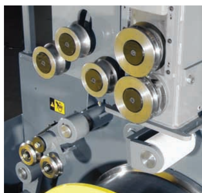
Rouleau de fin de fil automatique pneumatique, tête d'alimentation motorisée et rouleaux de fil
